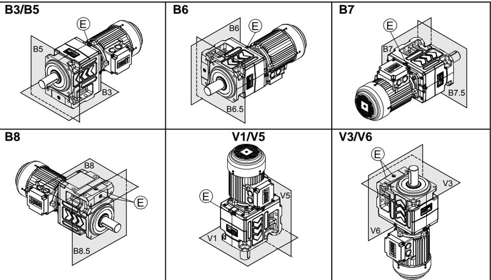
Ⓔ ... Position der Entlüftungsschraube
