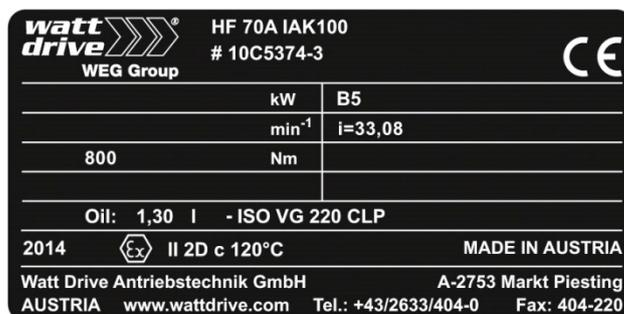
Getriebe im EX-Bereich / Gear unit in ex-area
