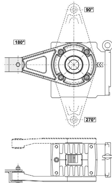
Bild 17: Kegelstirnradgetriebe
