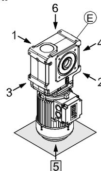
(E) ... Position der Entlüftungsschraube
