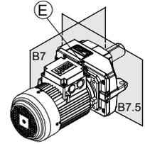
(E) ... Position der Entlüftungsschraube
