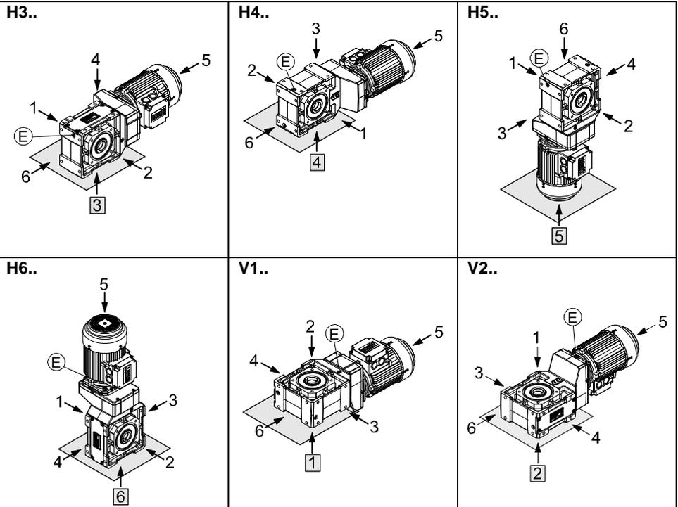
(E) ... Position der Entlüftungsschraube
