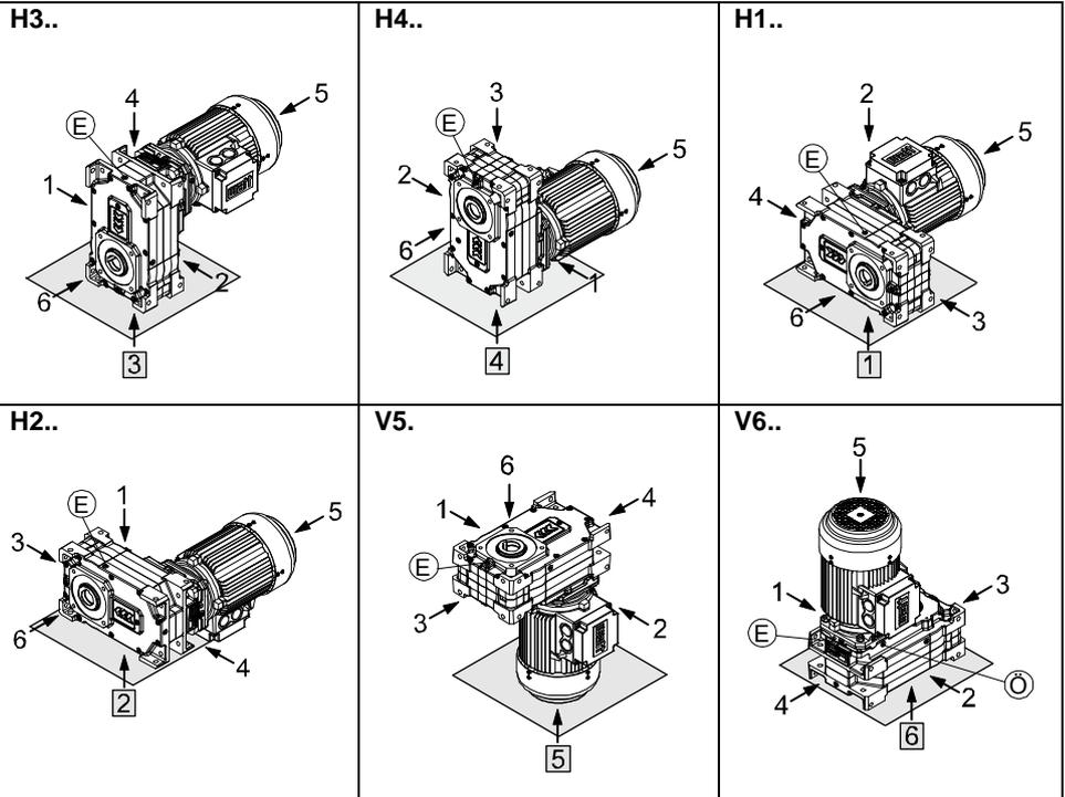
(E) ... Position der Entlüftungsschraube
