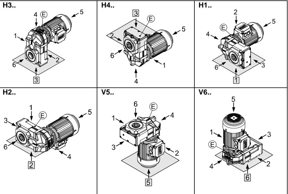
Ⓔ ... Position der Entlüftungsschraube
