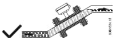
Bild 4-2 Korrekt installation med fyllt rör
